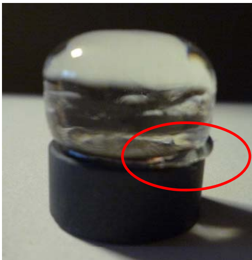
(図4)接着剤が過剰にはみ出し 商品として不細工
